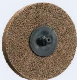
Unitized (verpresste) Scheiben haben ein breites Einsatzspektrum in der Oberflächenbearbeitung. Besonders geeignet zum Entgraten von Rillen, Nuten und Gewinden, Beischleifen von Legierungen, Polieren und Finishen.
