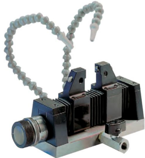
Seiten-Abrichtgerät SAV 434.06 - K, Typ PWA 28 - K, mit Kühlsystem
